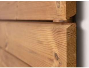
Die extra breiten Leisten dieses Rhombus-Zaunes sorgen für ein flächiges Element, das nur wenig Durchsicht gewährt. Die breiten Profile werden auf senkrechten Konstruktionsleisten verschraubt, die beiden äußeren werden jeweils ca. 33 mm eingerückt. Dadurch können die Elemente in die genuteten Systempfosten aus Aluminium eingebaut werden. Einseitig sind die konstruktiv notwendigen Leisten sichtbar. Deko-Elemente sorgen für weitere Gestaltungsmöglichkeiten. Preis je Element 251,00 brutto
